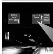
3M™ ダイヤモンドグレード™ DG³ 超高輝度反射シートは、マイクロリプリケーション(高精細表面)技術によってほぼ100%の反射面をもつ夜間でも明るく見やすい、反射シートです。
