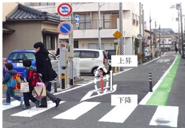
ライジングボラード（新潟市中央区栄町） ※平日 7:30-8:15（通学時間帯）に通行規制 国土交通省写真提供
